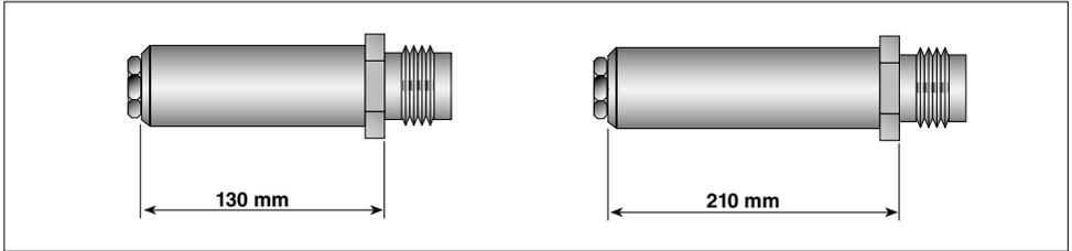
**TESTE PROLUNGATE A SEZIONE RIDOTTA - EXTENDED HEADS WITH REDUCED SECTION - TÊTES ALLONGÉES AVEC SECTION RÉDUITE - VERLÄNGERTE KÖPFE MIT VERKLEINERTEM QUERSCHNITT - CABEZAS ALARGADAS DE SECCION REDUCIDA - GŁOWICE WYDŁUŻANE O ZREDUKOWANYM PRZEKROJU - УДЛИНЕННЫЕ ГОЛОВКИ С ЗАНИЖЕННЫМ СЕЧЕНИЕМ**
